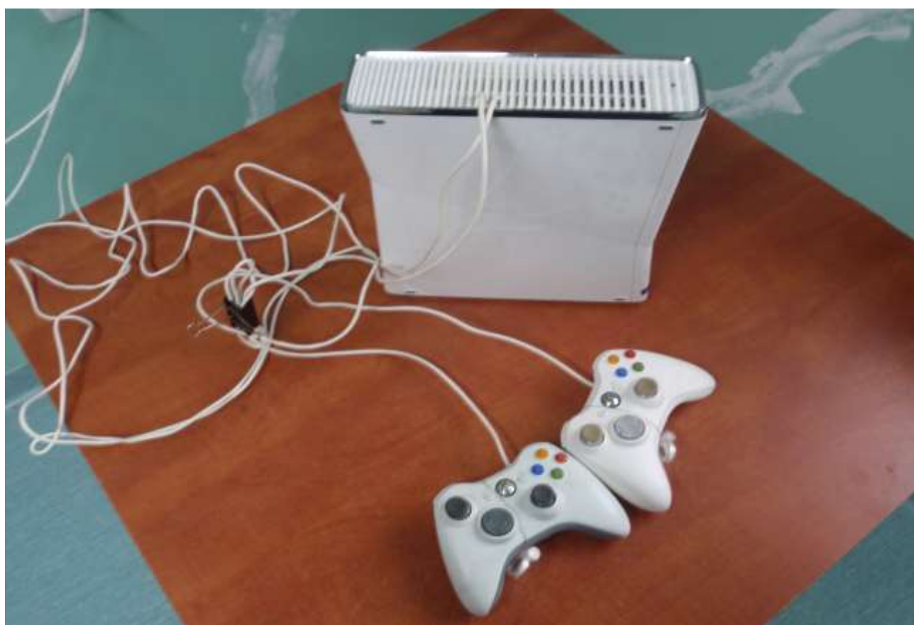
zdj. 1 i 2 Kontroler zintegrowany z konsolą przy pomocy odpowiedniego kabla. (brak złącz USB – kontroler przewodowy).
